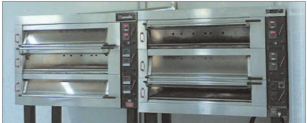
Les deux fours électriques modulables spécial pâtisserie sont équipés de soles indépendantes qui permettent de cuire des tartes, des pâtisseries et du pain à l'occasion.
