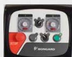
**Electromécanique** avec deux minuteurs, accompagnés d'un sélecteur permettant d'activer chaque vitesse indépendamment et d'un autre pour le choix du sens de rotation de cuve (modèles 80 et plus).
