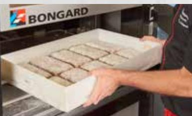
Nach Abschluss der Teigbereitung und Ablage des Teigs im Trichter geht alles automatisch vonstatten: Das Wiegen ist integriert, und das Bemehlen, das Falten sowie das Einlegen der Teiglinge in die Wannen erfolgen selbsttätig.
