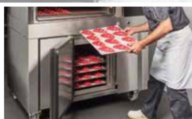
Die Temperatur und die Luftfeuchtigkeit können je nach Produkt, das in den **Gärraum** geschoben wird, eingestellt werden.
