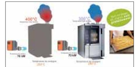
Cette pièce maîtresse permet aujourd'hui d'abaisser considérablement la température de sortie des fumées grâce à l'amélioration des performances d'échange thermique et à la récupération de l'énergie dégagée afin de la réintroduire dans le processus de cuisson.
