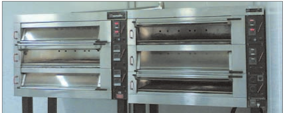
Les deux fours électriques modulaires spécial pâtisserie sont équipés de soles indépendantes qui permettent de cuire des tartes, des pâtisseries et du pain à l'occasion.
