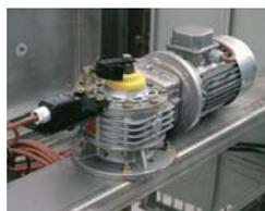
Traditionnellement, lorsqu'une plaque est mal engagée sur un chariot, celui-ci se bloque inévitablement. Un dispositif de sécurité est alors indispensable pour éviter toute détérioration du moteur, des tôles de soufflage et des plaques de cuisson. Pour pallier ce problème, un **limiteur de couple** permet au motoréducteur de patiner et de continuer normalement la cuisson, dès que la plaque est repositionnée correctement.
