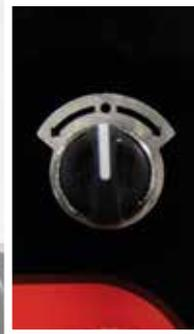
Sélection du sens de rotation de la cuve, couvercle levé, pour un **décuvage** et **nettoyage aisés** (sur modèles TC 80 et plus).
