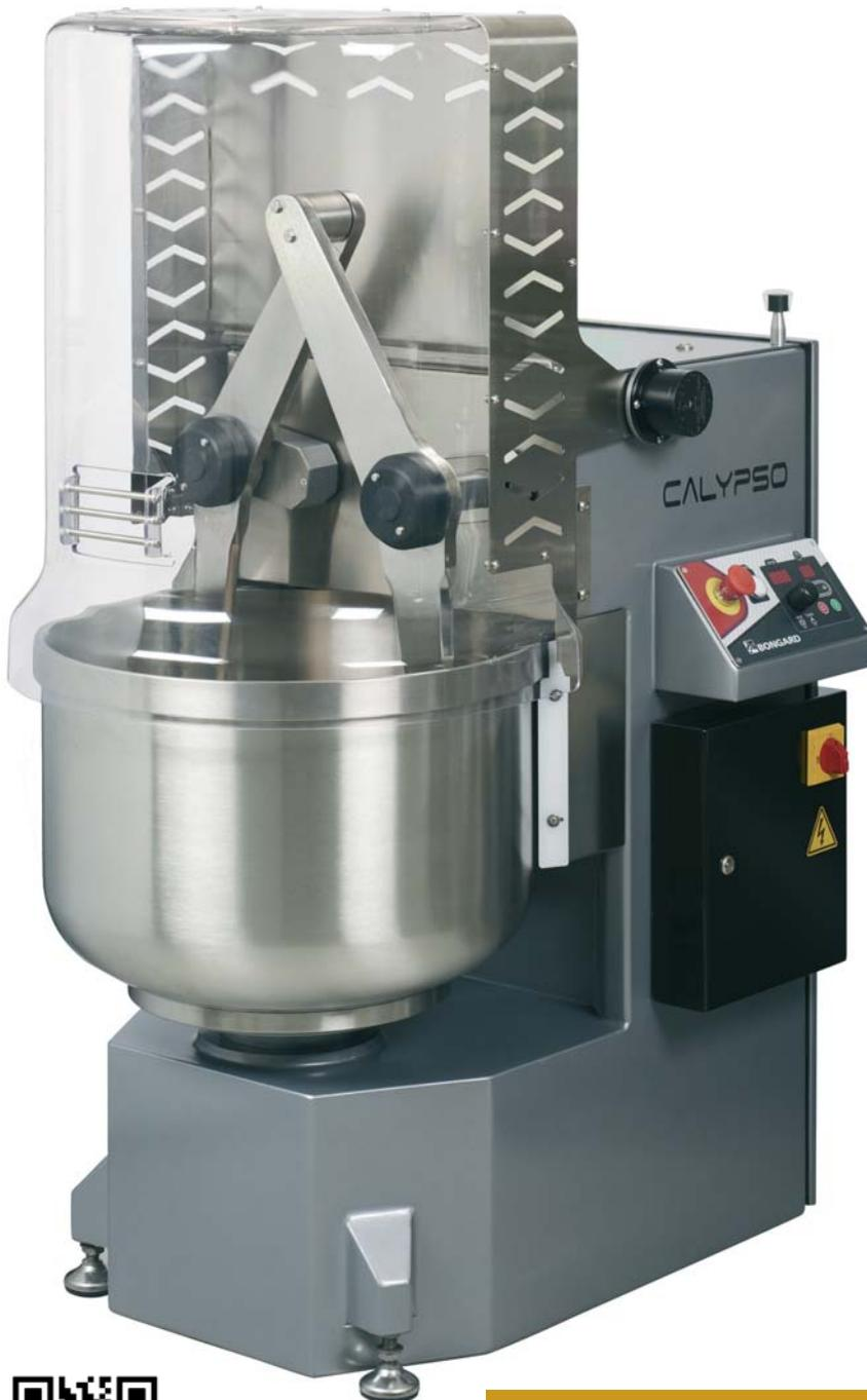
Le pétrin **CALYPSO** est constitué de 2 bras qui viennent soulever et étirer délicatement la pâte, reproduisant ainsi les mouvements du **pétrissage manuel**. Le réseau glutineux est parfaitement développé, sans matraquer ni échauffer la pâte.
