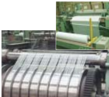
Des métiers à tisser pour la toile inox et la fibre de verre.
