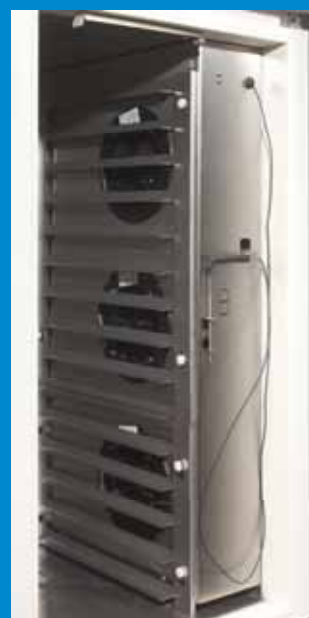
3 ventilateurs « grand-froid » équipant le surgélateur BSP 46.15.
