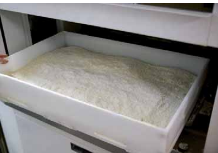
Zuerst senkt sich eine flache Andrückplatte auf den Teig, Der ausgeübte Druck beträgt nur einen Bruchteil im Vergleich zu der Kraft eines Hydraulikteilers. Anschließend hebt sich die Platte, und der Teilkopf im Inneren dreht sich einen Schritt weiter, bis die gewünschte Matrize über dem Rahmen zum Stehen kommt und den Teig einteilt.
