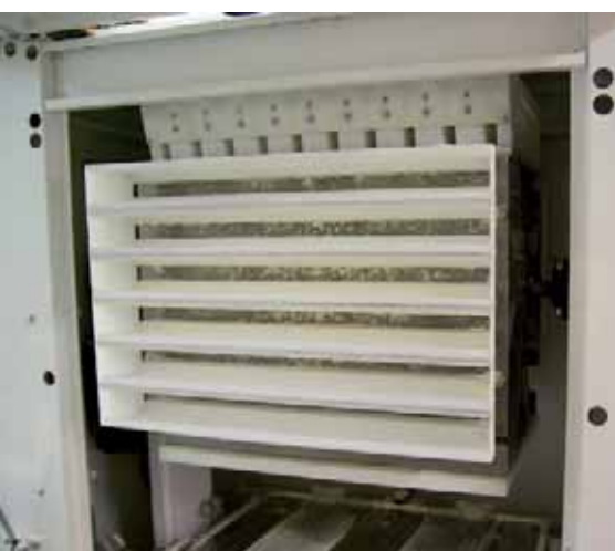
Der Teilkopf in der Maschine ist wie eine quadratische Trommel. Das Edelmessermesser ist mit einem speziell geformten Kunststoff umgeben, da der Teig nicht wie mit einem Messer geschnitten werden soll. Der Kunststoff zieht beim Einteilen die Teigoberfläche mit nach unten zum Boden. So werden die Teigränder geschlossen.
