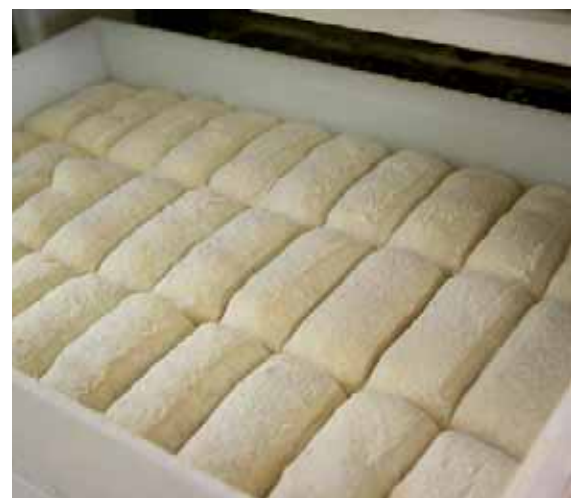
Zuerst senkt sich eine flache Andrückplatte auf den Teig, Der ausgeübte Druck beträgt nur einen Bruchteil im Vergleich zu der Kraft eines Hydraulikteilers. Anschließend hebt sich die Platte, und der Teilkopf im Inneren dreht sich einen Schritt weiter, bis die gewünschte Matrize über dem Rahmen zum Stehen kommt und den Teig einteilt.
