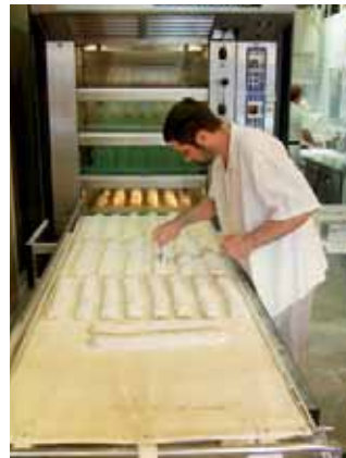
Die Baguettes auf dem Kunststoffboden des Rahmens können direkt abgenommen und auf den Abziehapparat gelegt werden. Eine Nachgärzeit wird nicht benötigt. Deutlich zeichnen sich Gärblasen auf dem frisch geteilten Teig ab.
