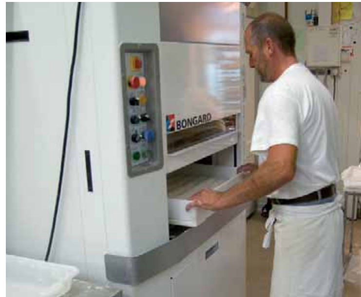
Glady zieht den Teig im Rahmen in Form und bewegt anschließend einen Mehler über den Rahmen. Ohne Staubentwicklung liegt nun eine durchgehend gleichmäßige, aber dünne Mehlschicht über dem Teig.
