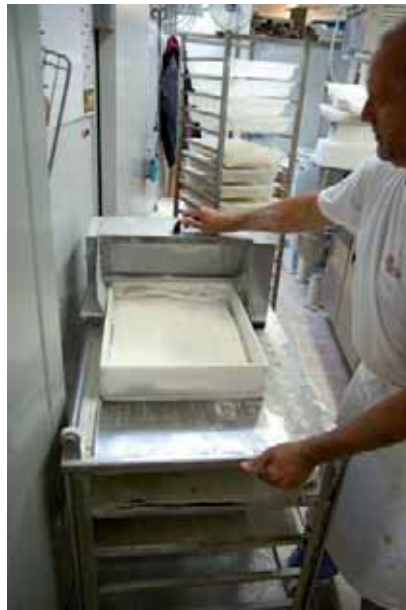
Glady zieht den Teig im Rahmen in Form und bewegt anschließend einen Mehler über den Rahmen. Ohne Staubentwicklung liegt nun eine durchgehend gleichmäßige, aber dünne Mehlschicht über dem Teig.
