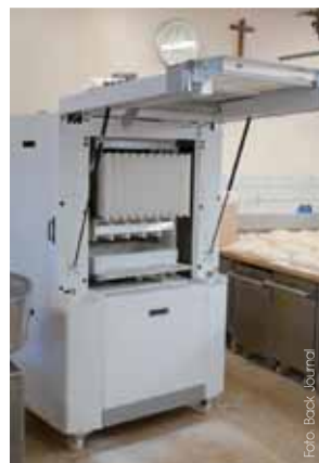
(Bild links): Direkt nach dem Auflegen auf Abziehapparate können die Teiglinge geschnitten und auch anschließend gebacken werden. (Bild rechts): Die große Frontklappe der Paneotrad Anlage erleichtert Reinigungs- und Wartungsarbeiten.
