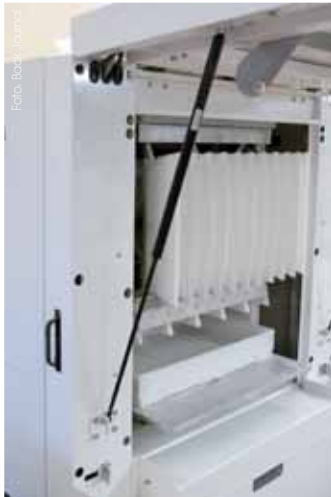
Bilder links u. Mitte: Details wie ein hydraulischer Halter für die große Frontklappe und die Führung der Kabel innerhalb des Gehäuses erleichtern die Reinigung der Anlage. In der Zubehörklappe in der Anlagenfront lassen sich weitere Matrizen griffbereit lagern. Bilder rechts: Die speziellen Teilwerkzeuge der Matrice sowie die Mechanik zum Anheben des Teigträgers sorgen für eine schonende Teilung des Teiges.
