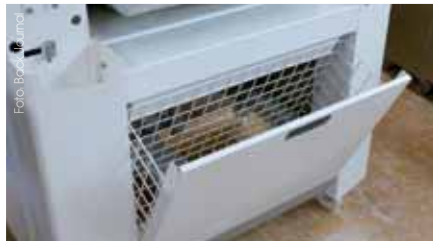
Bilder links u. Mitte: Details wie ein hydraulischer Halter für die große Frontklappe und die Führung der Kabel innerhalb des Gehäuses erleichtern die Reinigung der Anlage. In der Zubehörklappe in der Anlagenfront lassen sich weitere Matrizen griffbereit lagern. Bilder rechts: Die speziellen Teilwerkzeuge der Matrice sowie die Mechanik zum Anheben des Teigträgers sorgen für eine schonende Teilung des Teiges.
